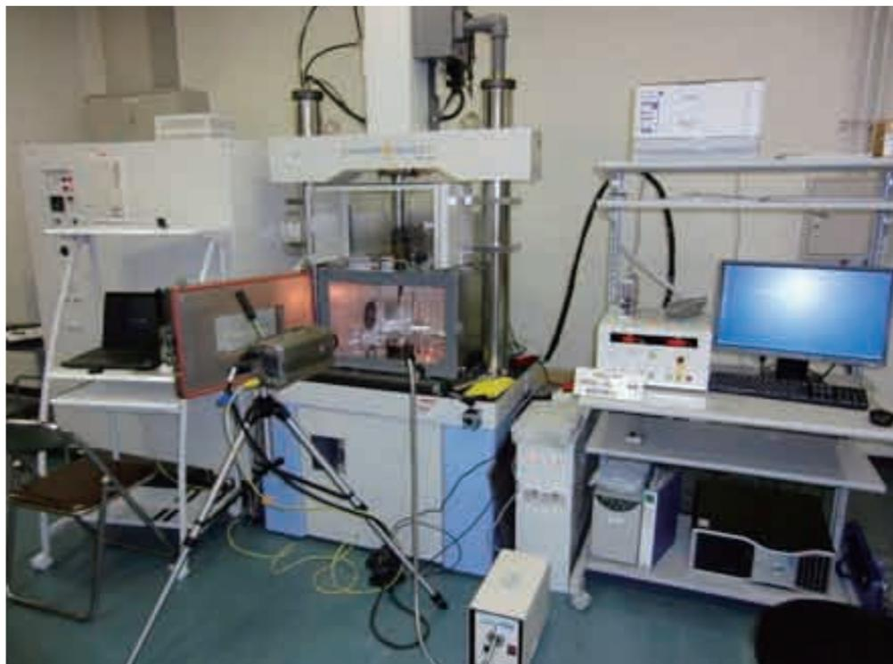
「高速引張り試験機」。試験片を高速で引っ張り、その引っ張られた時の伸びや、破断時における力を計測します
