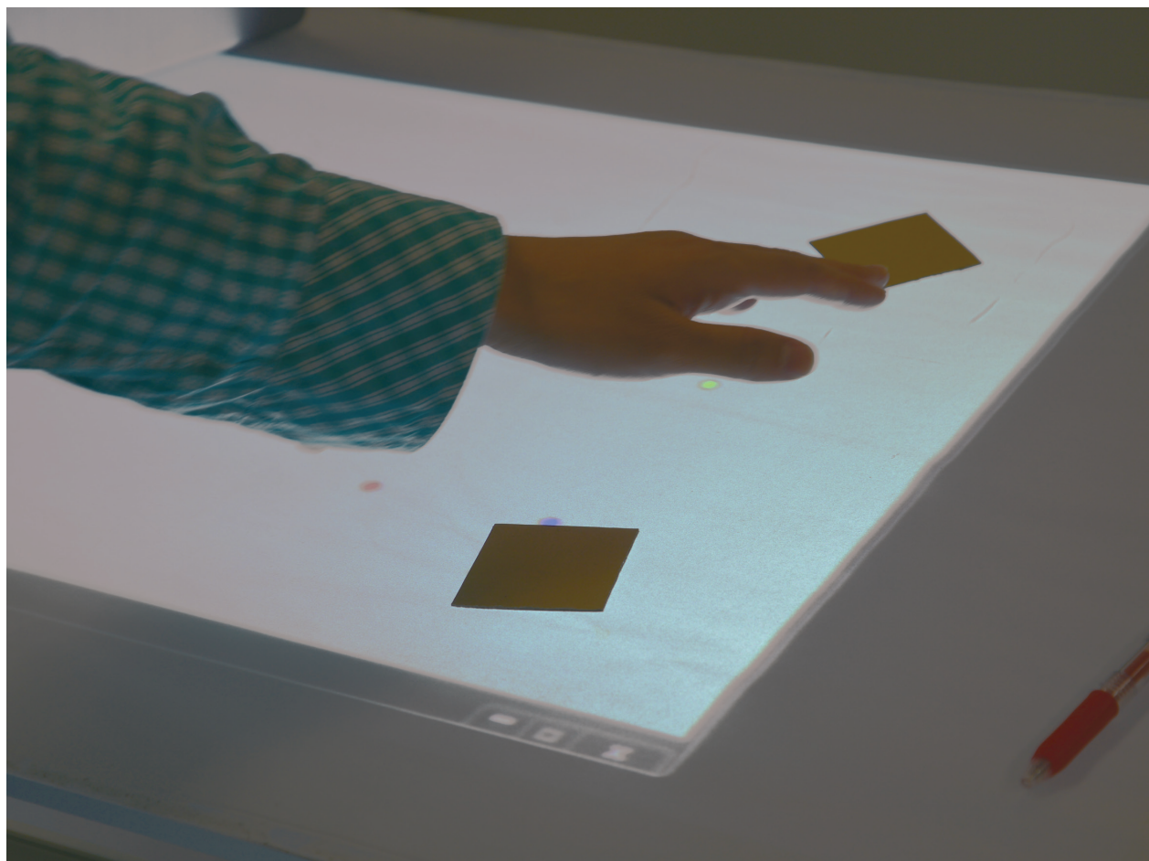
ライトテーブル上のマークを手で動かし、 ロボットをコントロールする仕組み
