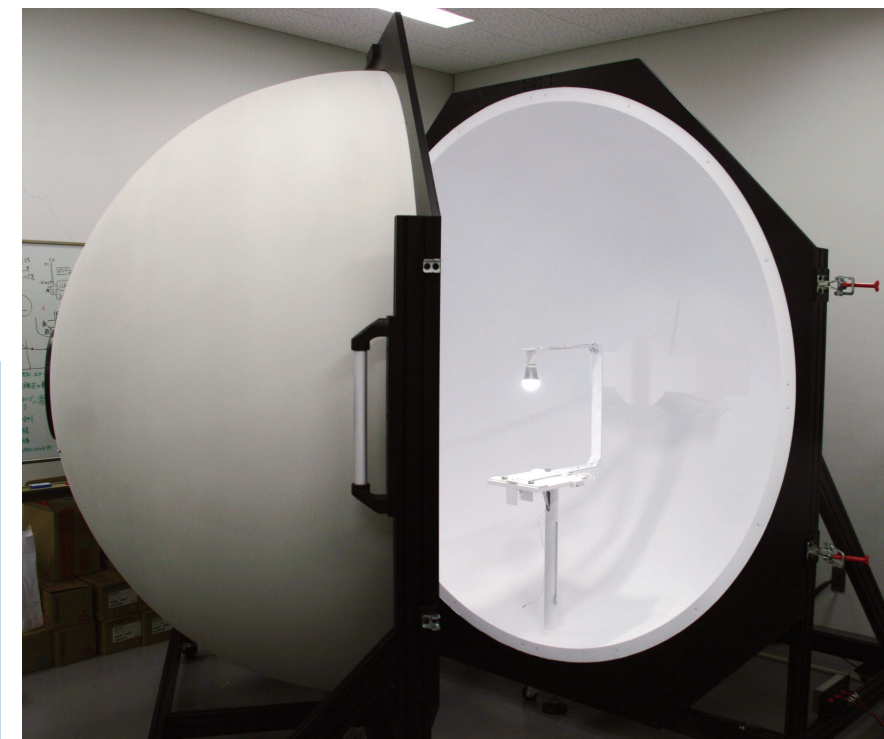
全光束測定システム。二つに割れるように開く球の中心に照明をセットし、閉じて計測する
