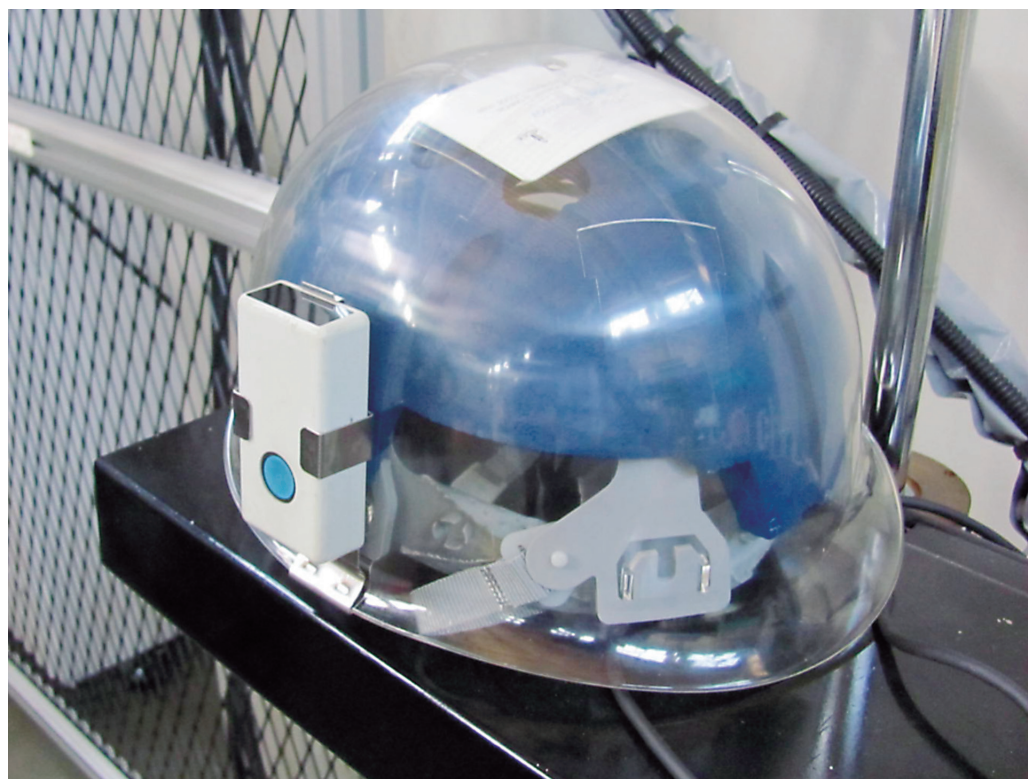
常に頭の位置が確認できるICタグのついたヘルメット
