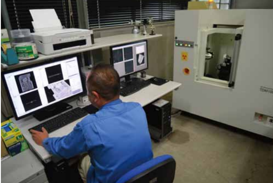
高精細X線CT装置の本体(右)とコントロールするパソコン
