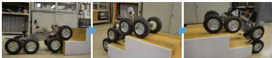
平地は8輪の内の4輪を接地して走る
