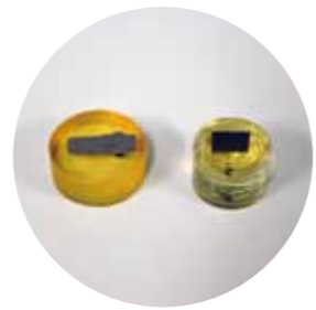
ネジをプラスチックで固定し断面で硬度を計測する
