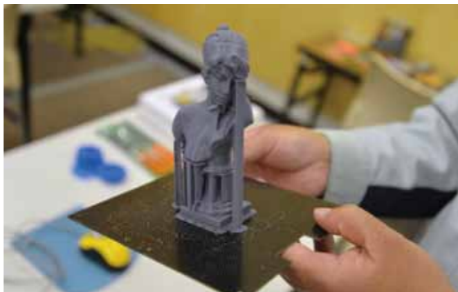
出力されたフィギュアには支えの棒など、余分なものがついている
