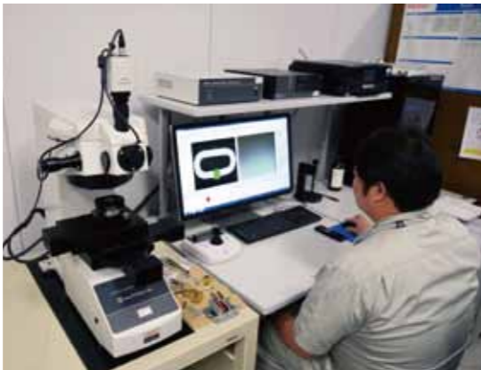
左の試験機に試料をセット、右のパソコンに測定結果が表示される
