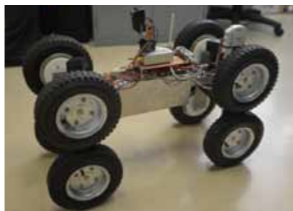
平地は8輪の内の4輪を接地して走る
