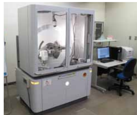
補助事業により導入したX線回折装置（XRD）。これまで難しかったさまざまな測定が可能になった
