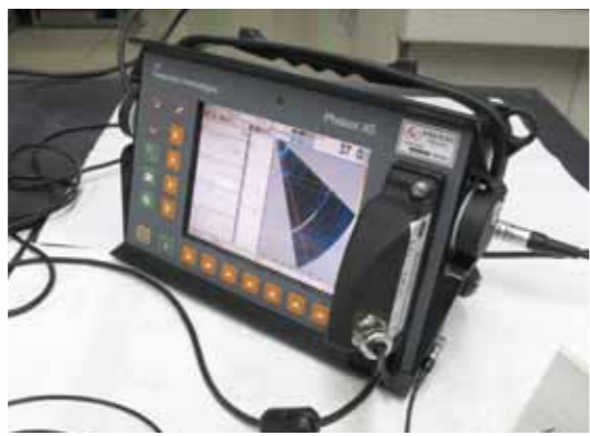
超音波探傷装置。対象の素材に超音波を当てて欠陥がないか調べられる
