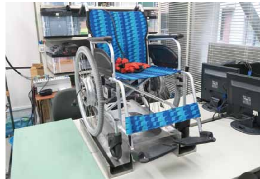
今回開発した、車いす搭乗用リフトに取り付けるタイプの免震装置
