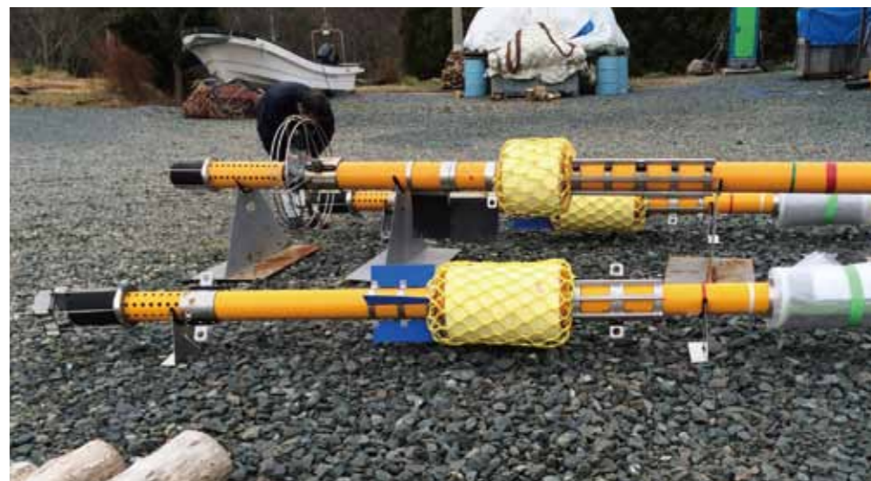
海上に浮かべての実験のようす(左写真)。試作した2種類の海上ブイ。写真手前が改良を加えた最新型(右写真)
