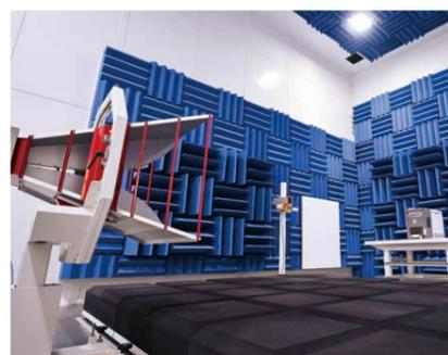
ディープフリーザーのEMC試験で使われた電波暗室。計測機器など試験設備の一部は、JKAの支援で導入されてきた
