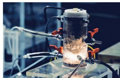
液中プラズマの実験装置。プラズマが光を放ち、水素が発生している
